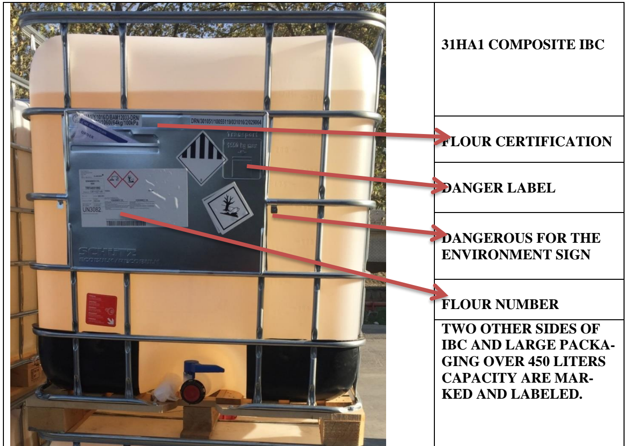
IBC (OHK) Labeling
